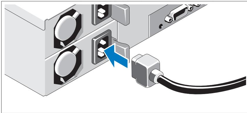
시스템의 전원 케이블을 시스템에 연결하고, 모니터를 사용하는 경우 모니터의 전원 케이블을 모니터에 연결합니다. 전원 케이블의 반대쪽 끝을 접지된 전원 콘센트나, UPS(무정전 전원 공급 장치) 또는 PDU(배전 장치)와 같은 별도의 전원에 연결합니다.
