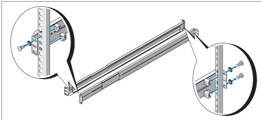
**2** 将机箱导轨上的锁孔槽分别对准系统两边的相应销，然后将机箱导轨滑向系统前端，直至其锁入到位。使用螺钉将机箱导轨固定在系统上。
