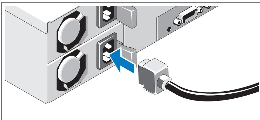
Hubungkan kabel daya sistem ke sistem dan, jika menggunakan monitor, hubungkan kabel daya monitor ke monitor. Tancapkan ujung kabel daya yang lain ke stopkontak listrik yang ditanahkan atau sumber daya terpisah seperti catu daya tak terputus (UPS) atau unit distribusi daya (PDU).
