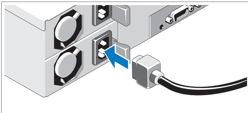
システムの電源ケーブルをシステムに接続し、モニターを使用する場合は、モニターの電源ケーブルをモニターに接続します。電源ケーブルのもう一方の端をアースされたコンセントまたは無停電電源装置（UPS）や配電装置（PDU）などの別の電源に接続します。
