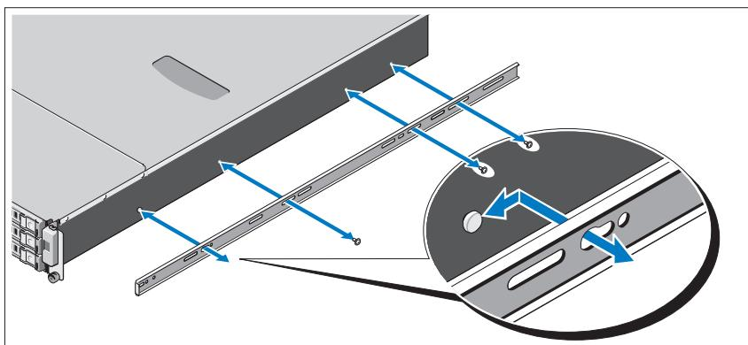
**3** 将机箱导轨末端对准导轨末端并插入，然后将系统往内推，直至机箱导轨锁入到位。
