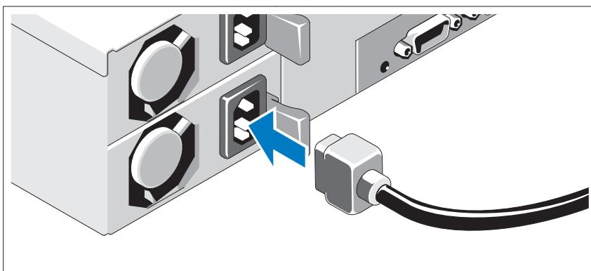
将系统电源电缆连接至系统，如果使用显示器，则将显示器电源电缆连接至显示器。将电源电缆的另一端插入接地的电源插座或单独的电源，如不间断电源设备 (UPS) 或配电装置 (PDU)。
